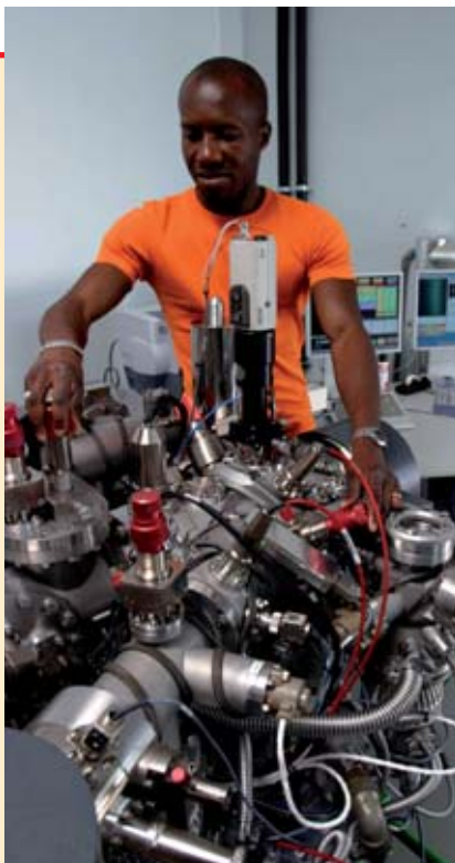
Spectromètre de masse d'ions secondaires utilisé au CEA pour réaliser des mesures isotopiques rapides sur un échantillon par exemple prélevé sur une installation aux activités nucléaires suspectes.
