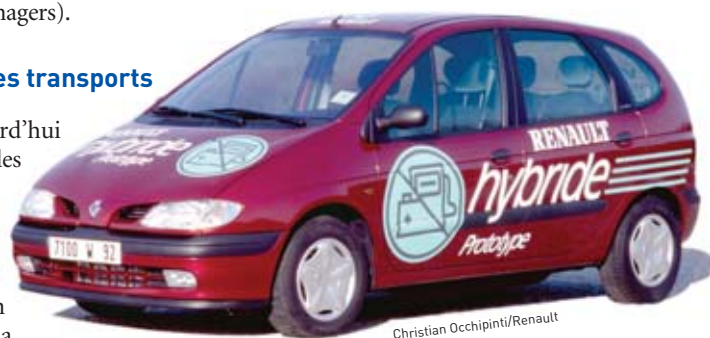
Véhicule hybride de type Scenic construit par Renault, doté à la fois d'un moteur thermique et de batteries électriques. Cette formule constitue une phase d'évolution probable vers l'automobile équipée, à plus long terme, d'une pile à combustible alimentée en hydrogène.
