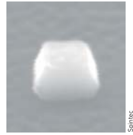
Première jonction tunnel magnétique submicronique pour mémoire MRAM réalisée par le laboratoire Spintec (largeur : environ 300 nm).
