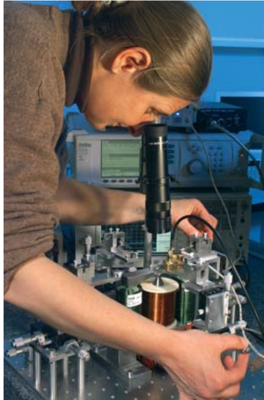
Banc de mesures électriques spectrales large bande (0-26 GHz) dédiés à l'étude de nanostructures magnétiques à courant polarisé en spin au CEA/Grenoble.
