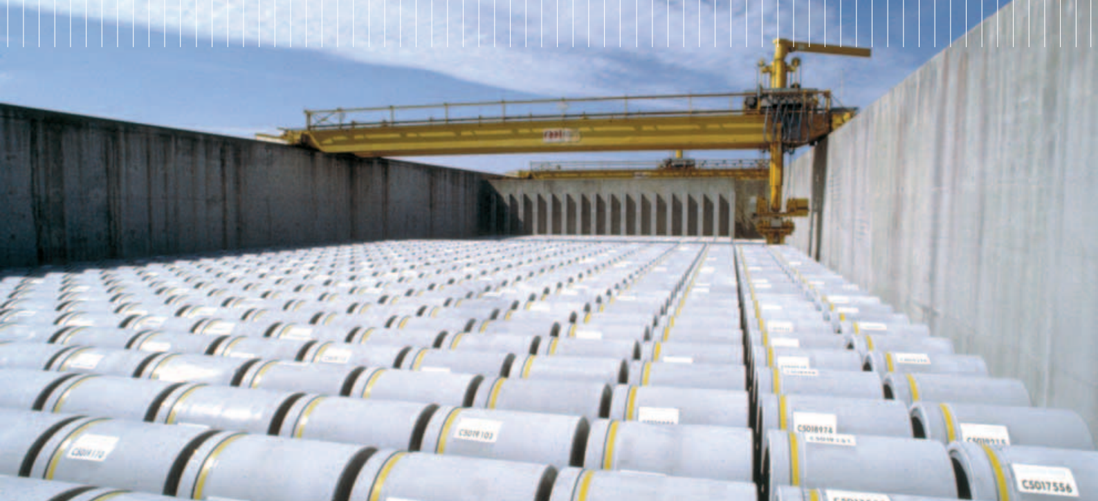
Colis de déchets cimentés dans l'atelier d'entreposage des déchets solides (EDS) à l'usine Areva/Cogema de La Hague (Manche).
