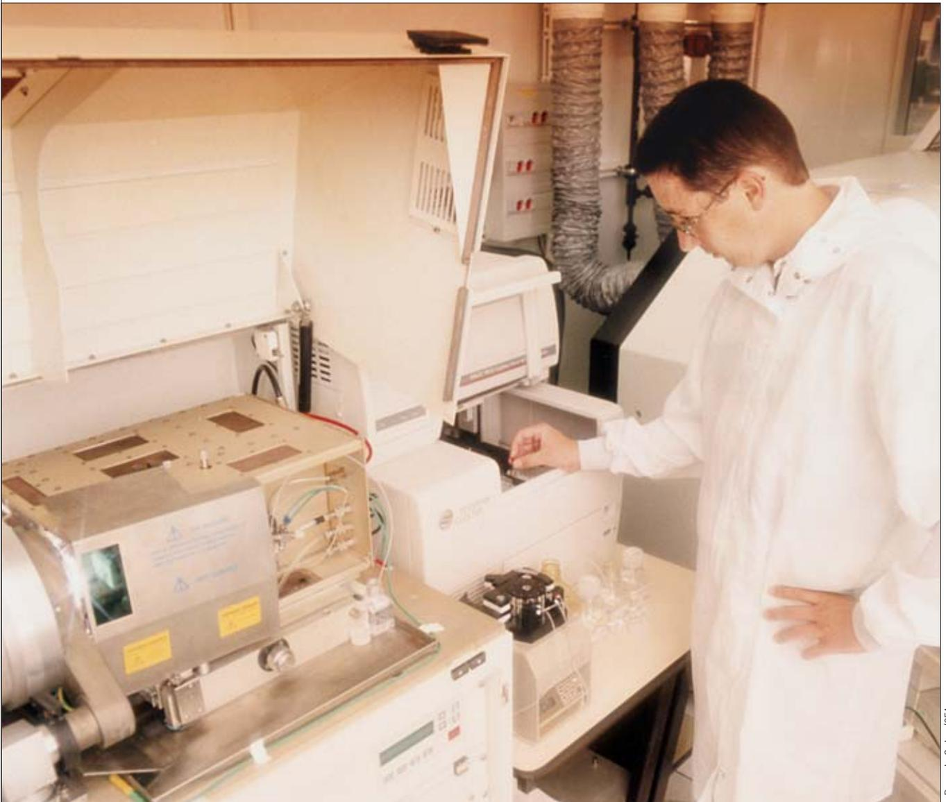
Couplage expérimental EC/ICP-MS utilisé pour déterminer la spéciation d'éléments dans l'environnement et en milieu biologique. Après mise en place de l'échantillon, les éléments sont séparés par électrophorèse capillaire (EC) puis détectés par spectrométrie de masse torche à plasma (ICP-MS) où le plasma atteint environ 7000 °C. Cette technique permet d'identifier, de caractériser et de quantifier les différentes formes physico-chimiques des éléments à des niveaux de concentration très bas.
