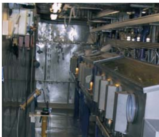
Batterie de mélangeurs-décanteurs, constituée de 12 éléments placés en série, utilisée de 1982 à 1994 pour la séparation des flux d'uranium et de plutonium lors du traitement des combustibles usés.
