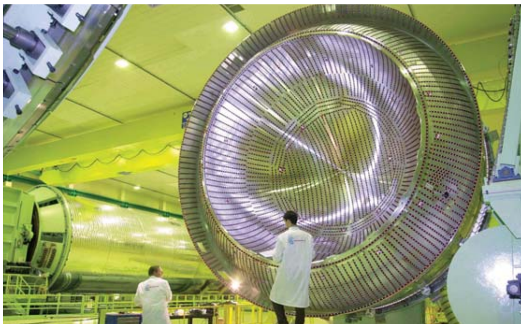
Étages cryogéniques du lanceur d'Ariane 5 en cours de soudage chez Cryospace (étage supérieur ESC-A au premier plan et étage principal EPC au second). La propulsion spatiale, bien que quantitativement limitée, constitue une première utilisation industrielle de l'hydrogène en tant que vecteur énergétique.
