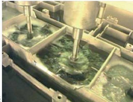
Décontamination par utilisation couplée de bains tensioactifs en milieu acide et d'agitation mécanique de cuves lors de l'assainissement de l'APM (Atelier Pilote de Marcoule).
