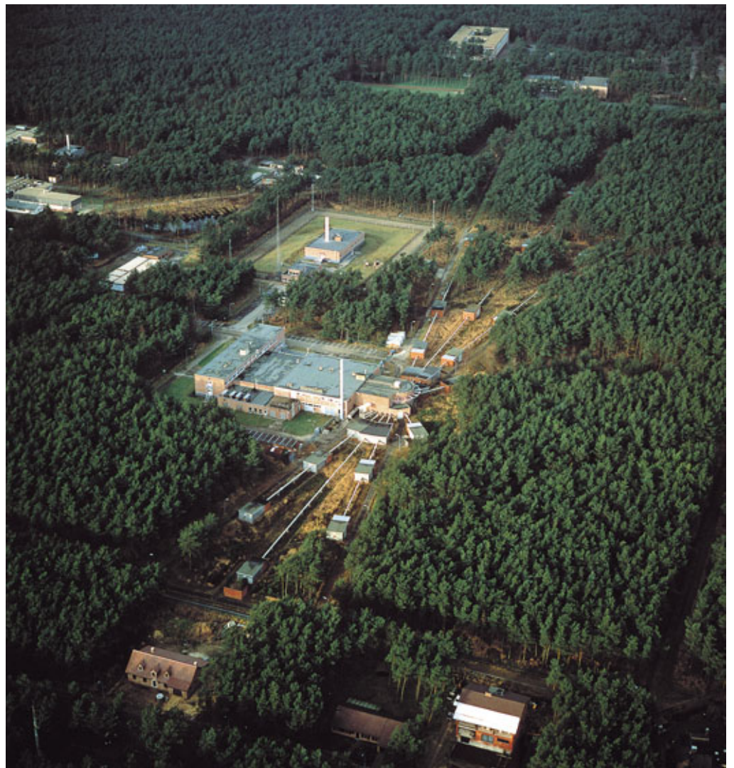
• • • • • Vue aérienne de l'accélérateur linéaire d'électrons Gelina (Geel Electron Linear Accelerator) et de ses bases de vol qui s'étendent jusqu'à 400 m. Ce dispositif expérimental fournit une source pulsée de neutrons dont la résolution en énergie est la meilleure parmi les installations actuelles.
