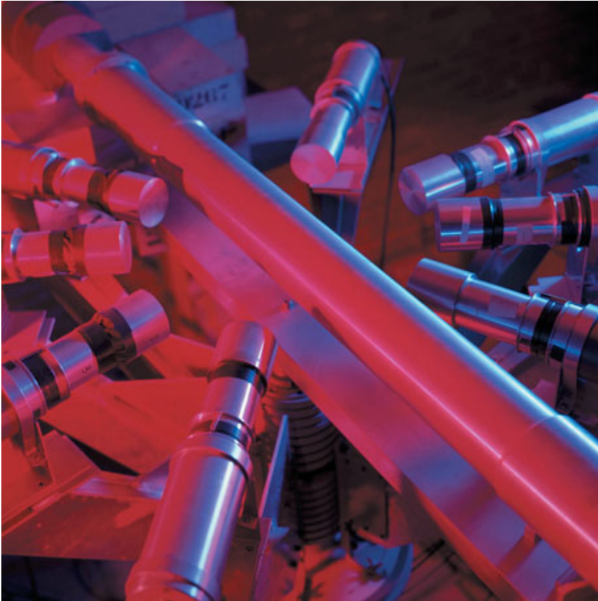
Dispositif de huit détecteurs servant à mesurer des sections efficaces de diffusion élastique et inélastique.
