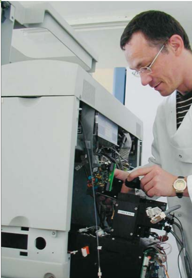
Adaptation d'une nouvelle tête optoélectronique dans l'automate Kryptor pour son utilisation dans le criblage des cibles moléculaires de l'uranyle dans le sérum humain.
