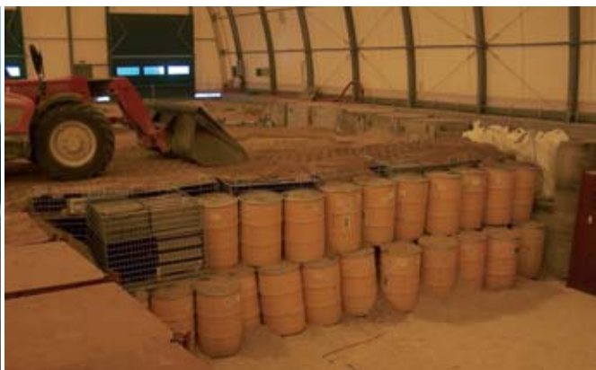
Au Centre de stockage de Morvilliers, les déchets TFA sont mis en place dans les alvéoles, protégés de la pluie par des toits mobiles.
