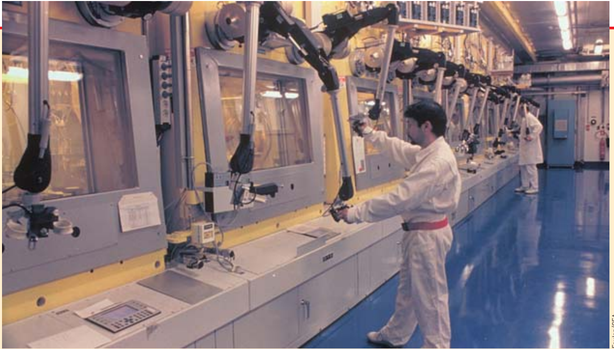
Techniciens aux télémanipulateurs d'une des chaînes de l'installation Atalante, au centre CEA de Marcoule. Blindées, ces chaînes arrêtent les rayonnements. Les opérateurs portent les dosimètres qui permettent d'en vérifier l'efficacité en permanence.
