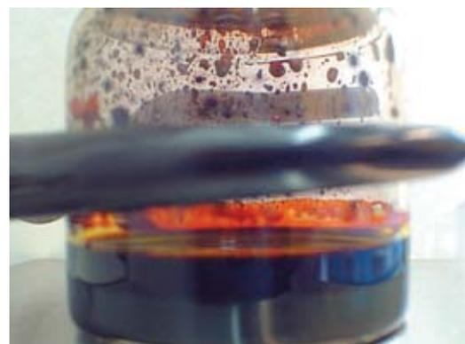
Réaction de Bunsen : séparation des deux acides obtenue lors d'une expérience effectuée au CEA/Saclay sur la décomposition de l'eau, par cycle thermo-chimique, pour la production d'hydrogène, selon le procédé iode-soufre.
