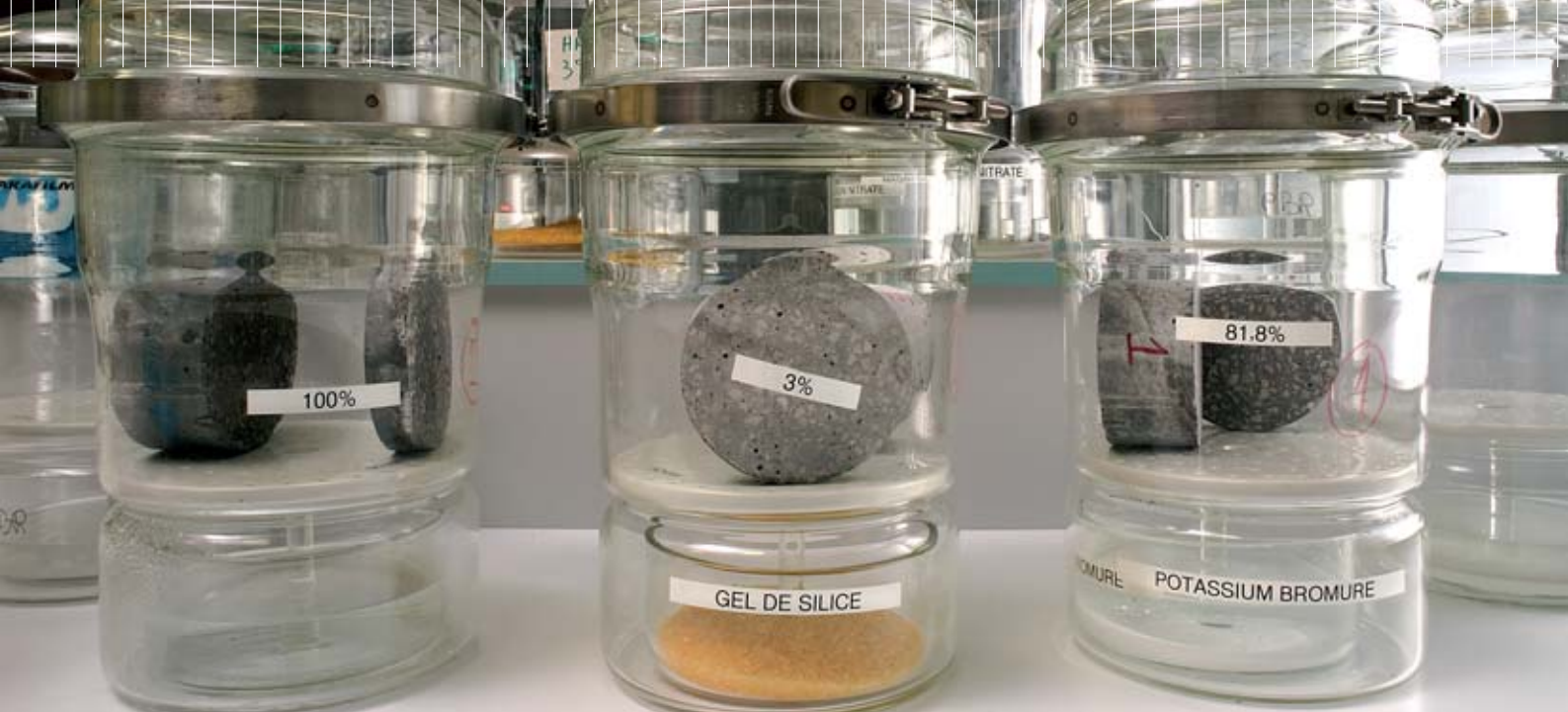
Dessiccateurs de préparation d'étalons de béton avant leur passage sur les bancs de test Banco (pour l'étude de la migration des chlorures) et Bandy (pour la mesure de la diffusion de l'hydrogène au travers du couvercle d'un conteneur de déchets MA-VL) au centre CEA de Marcoule.
