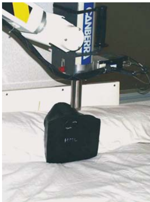
“Fantôme” pour l'étalonnage d'un détecteur d'irradiation thyroïdienne au service médical de Cogema Marcoule.
