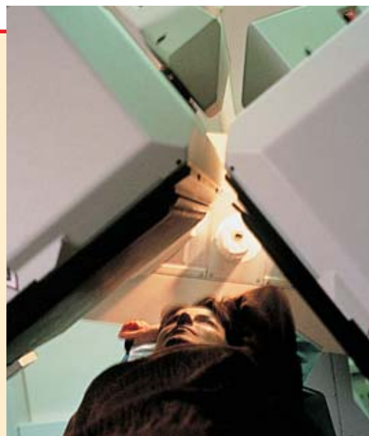
Scintigraphie conventionnelle réalisée au Service hospitalier Frédéric Joliot (SHFJ). La gamma caméra permet d'obtenir une imagerie fonctionnelle d'un organe après administration, le plus souvent par voie intraveineuse, d'un médicament radioactif (radiopharmaceutique) au patient. Les radionucléides utilisés sont spécifiques de l'organe étudié : par exemple, le technétium 99m pour les reins et les os, le thallium 201 pour le myocarde. Le radiopharmaceutique injecté émet de simples photons gamma captés par deux détecteurs plans qui sont placés à 180° ou à 45° selon l'examen.
