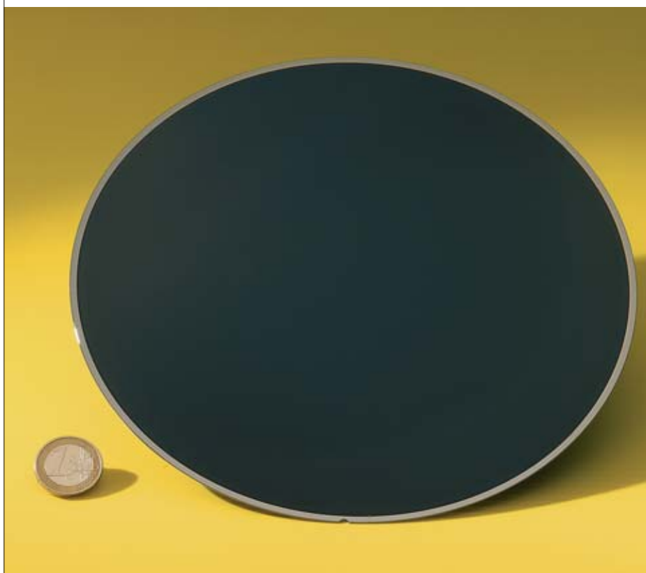
Nanotubes de carbone déposés sur un substrat de silicium.
