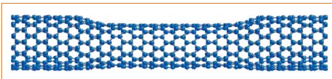
Figure 3. Schéma d'une jonction intramoléculaire métal/semi-conducteur/métal dont la stabilité est prédite théoriquement. Les hélicités des tronçons sont respectivement (12,0), (11,0) et (12,0).
