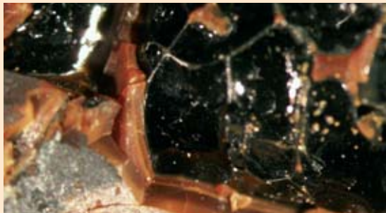
Le produit d'altération des verres basaltiques, la palagonite, est un analogue du gel d'altération des verres nucléaires borosilicatés.
