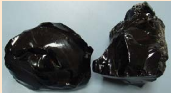
Un verre volcanique (à gauche) peut être considéré comme un analogue naturel du verre nucléaire de type R7T7 (à droite).
