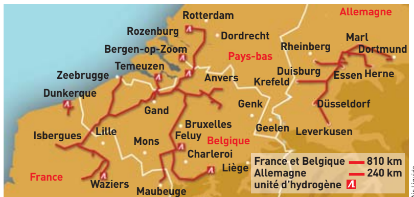
Figure. Réseau de distribution d'hydrogène gazeux par canalisation à 100 bars du groupe Air Liquide en France, au Benelux et en Allemagne.
