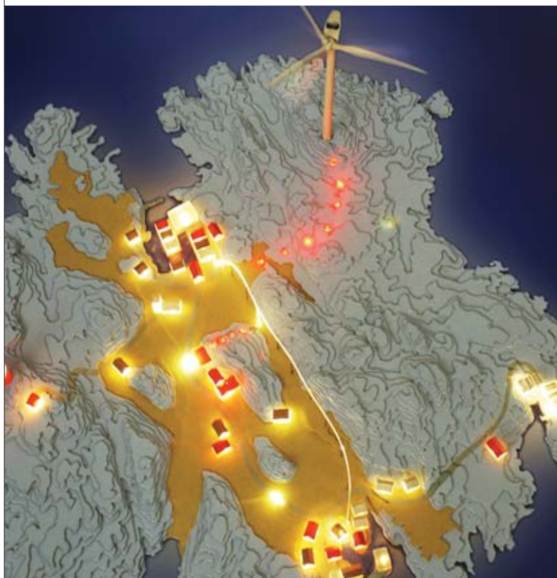
Maquette schématisant l'ensemble du système électrogène autonome éolien-hydrogène utilisé dans le projet de démonstration d'Utsira.
