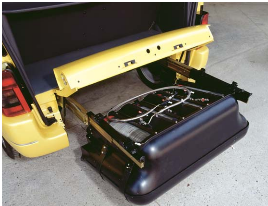
Rack des réservoirs d'hydrogène sous haute pression du prototype de véhicule à pile à combustible TaxiPac sur base Peugeot Partner présenté en 2001.
