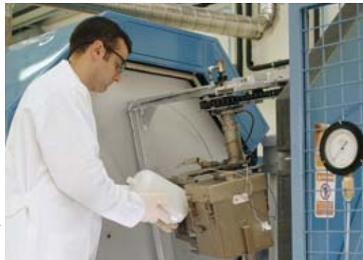
Installation de rotomoulage, au centre CEA du Ripault (Indre-et-Loire), des vessies plastique de réservoirs pour le stockage de l'hydrogène. Le moule tourne en 3 dimensions dans un four à 350 °C.
