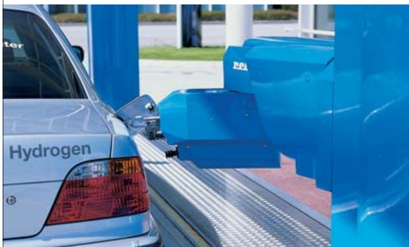
Station robotisée pour l'approvisionnement en hydrogène liquide à l'aéroport de Munich.
