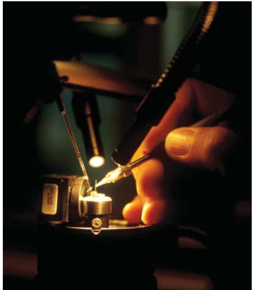
Préparation de la microcible d'une expérimentation de fusion inertielle.
