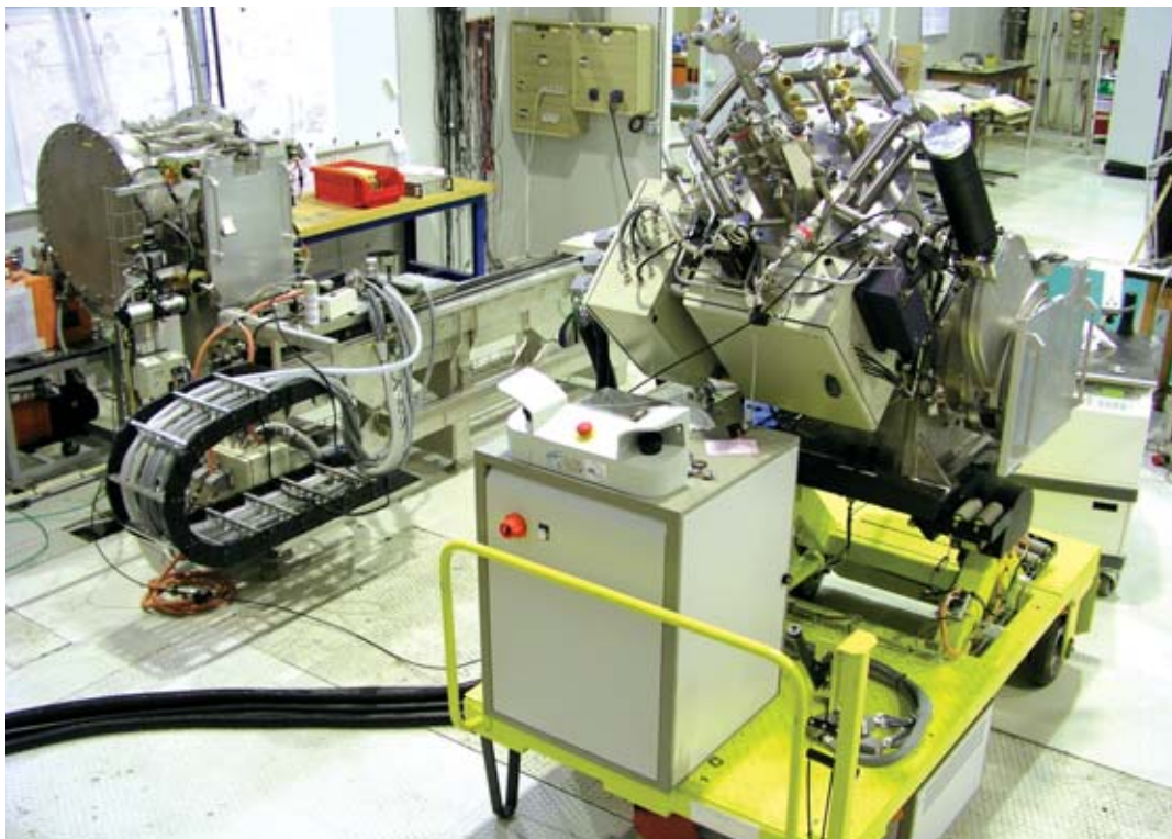
Prototypage du porte-cible cryogénique (PCC) en cours d'exploitation en collaboration entre le CEA/Grenoble (Service des basses températures) et le Cesta (Département des lasers de puissance). Cet équipement livré en 2002 a permis de valider les performances de régulation thermique de la pince cryogénique. Les performances mécaniques (précision de positionnement et chargement d'une cible sous vide, à froid, et en mode entièrement automatique) sont en cours de démonstration.
