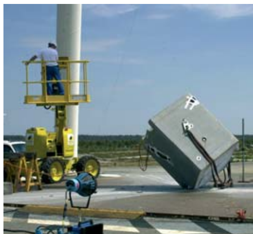
Test de chute d'une hauteur de 6 m, réalisé au CEA/Cesta, d'un démonstrateur de conteneur en béton (commun à l'entreposage de longue durée et au stockage), destiné à recevoir 4 colis primaires de fûts bitume. Le couvercle est resté solide du corps et les principales dégradations ont été limitées à la zone d'impact.
