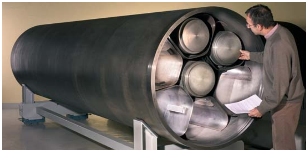
Démonstrateur de conteneur d'entreposage capable de recevoir sept assemblages UOX (figure 3).
