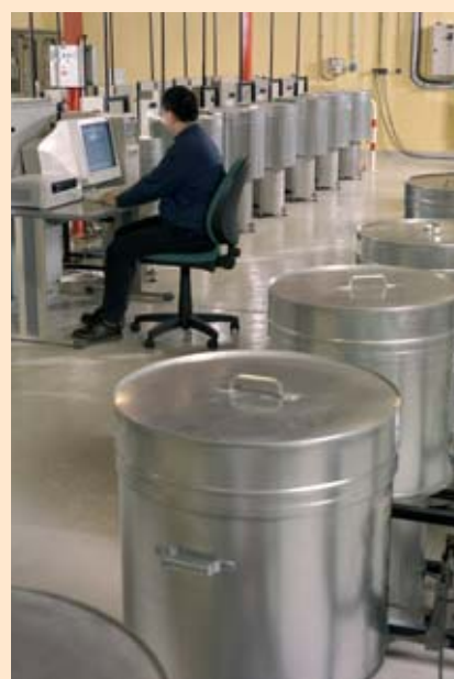
Plate-forme pour les essais de durabilité des matériaux métalliques soumis à un environnement en température. Les essais, commencés en 2002, ont pour objectif de suivre l'évolution des propriétés au fil du temps.
