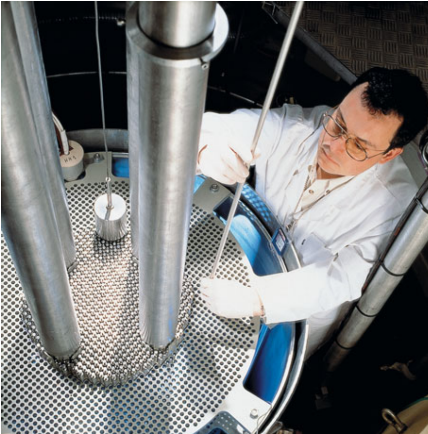
Mise en place dans le cœur de la maquette critique Éole d'aiguilles de combustible d'oxyde d'uranium.
