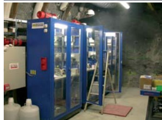
Expérimentations DIR réalisées dans la niche expérimentale à -445 m du Laboratoire de recherche souterrain de Bure (Meuse/Haute-Marne) de l'Andra. En haut, le concept expérimental retenu avec l'injection des traceurs dans une chambre d'injection en fond de forage. En bas, les armoires expérimentales dans lesquelles sont effectués les prélèvements et le suivi in situ des expériences menées actuellement au sein de la niche expérimentale.
