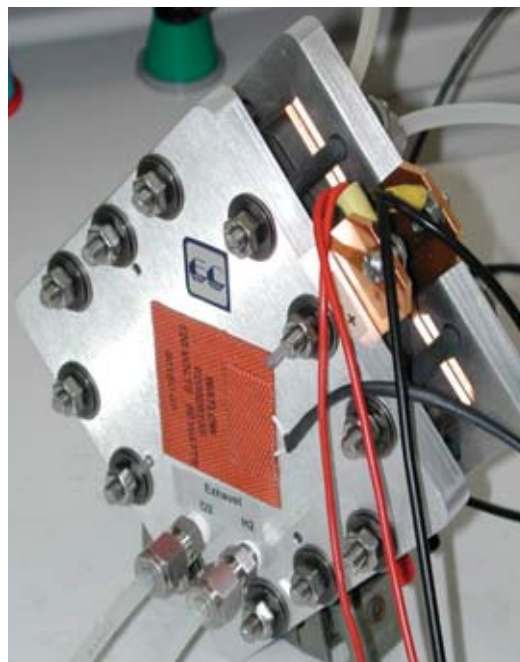
Pile à combustible de type PEMFC sur laquelle ont été réalisés des essais pour développer de nouveaux catalyseurs.
