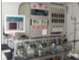
Banc de test automatique simultané de 4 mono-cellules indépendantes. En haut, cellules de test régulées en température. En bas, vue d'ensemble.
