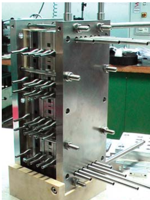
Empilement CEPACPOR constitué de trois cellules de 225 cm 2 à distributeurs en mousses métalliques et équipé de mesures de densité de courant.
