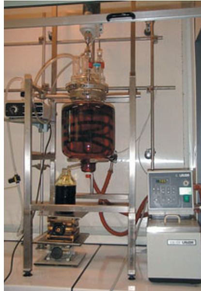
Réacteur utilisé au CNRS/LMOPS pour la synthèse des polyimides sulfonés entrant dans la composition de membranes conductrices protoniques à hautes performances.
