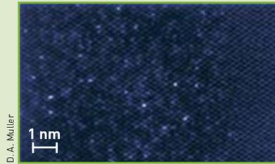
Figure E1. Visualisation d'atomes uniques (dopant Sb) dans des colonnes de Si. Chaque point plan représente deux colonnes d'une vingtaine d'atomes de silicium. Les colonnes les plus brillantes contiennent un, deux ou trois atomes de dopants (Sb). Image réalisée avec un TEM JEOL-200kV fonctionnant en mode STEM par D. A. MULLER, *Nature*, vol. 416, 826 (2002).
