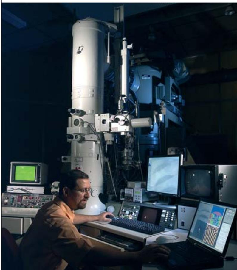
Microscope électronique à transmission (MET) JEOL de 400 kV au CEA/Grenoble. Actuellement équipé d'une caméra CDD haute résolution, cet instrument, qui a été le plus performant du monde avec une résolution inférieure à 0,17 nm, permet de visualiser des défauts dans des structures cristallines.
