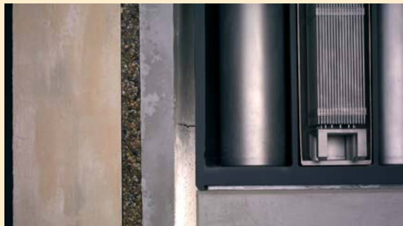
Coupe d'un puits d'entreposage expérimental d'un conteneur de combustible usé (le bas de l'assemblage est visible en haut à droite) dans la galerie Galatée du Cecer (Centre d'expertise sur le conditionnement et l'entreposage des matières radioactives) au centre CEA de Marcoule, mettant en évidence la juxtaposition d'enveloppes.
