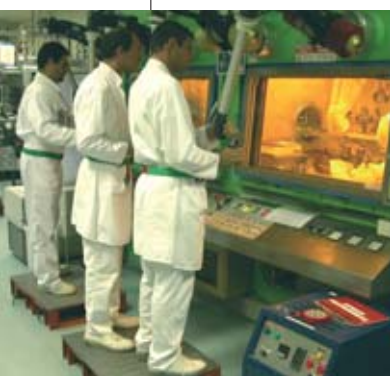
Laboratoire de fabrication des matrices céramiques développées pour le conditionnement des radionucléides à vie longue.
