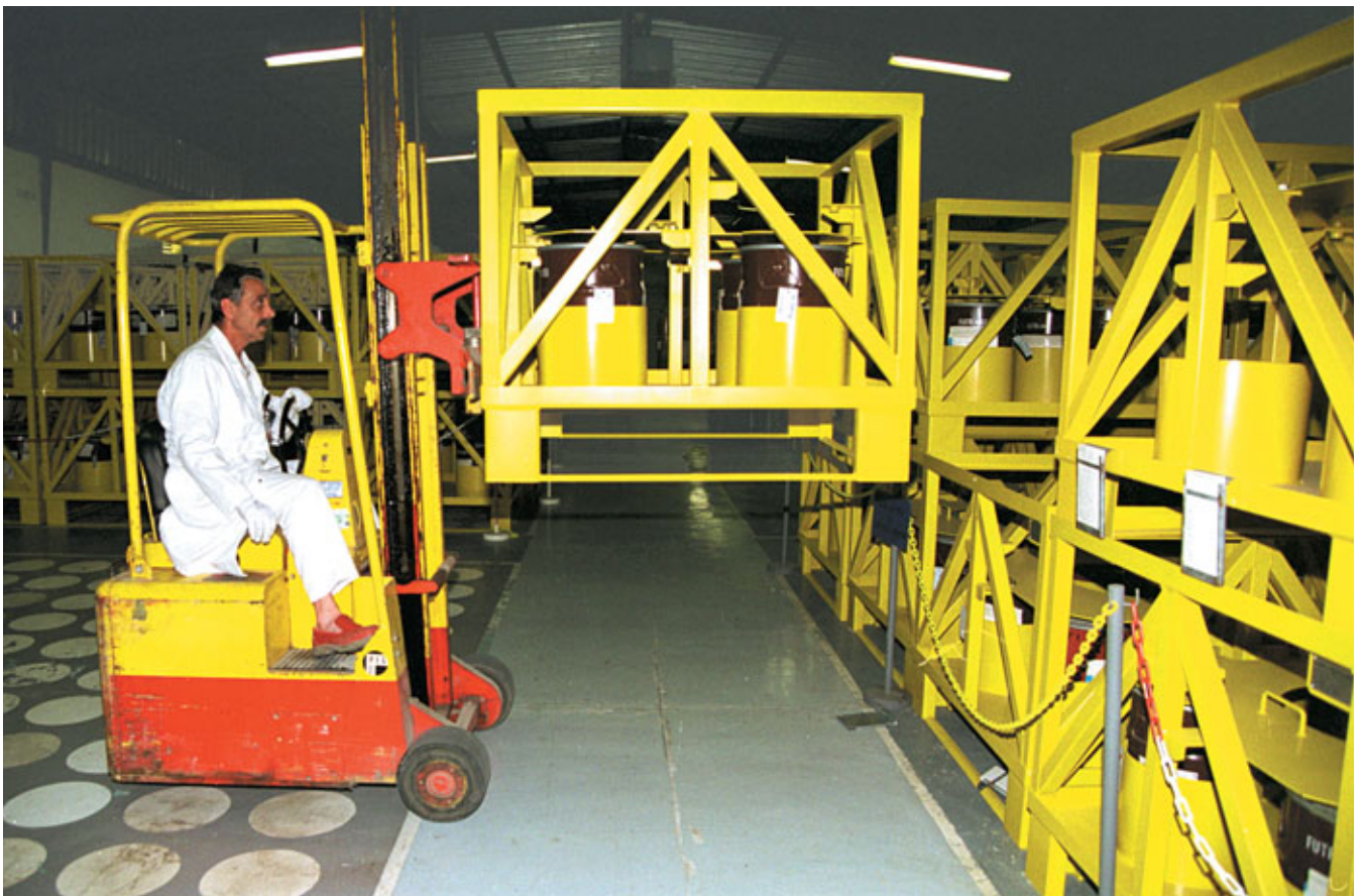
Manutention au CEA/Cadarache de matières fissiles non irradiées conditionnées en fûts et entreposées dans des "cages centrées" pour se prémunir du risque de criticité.
