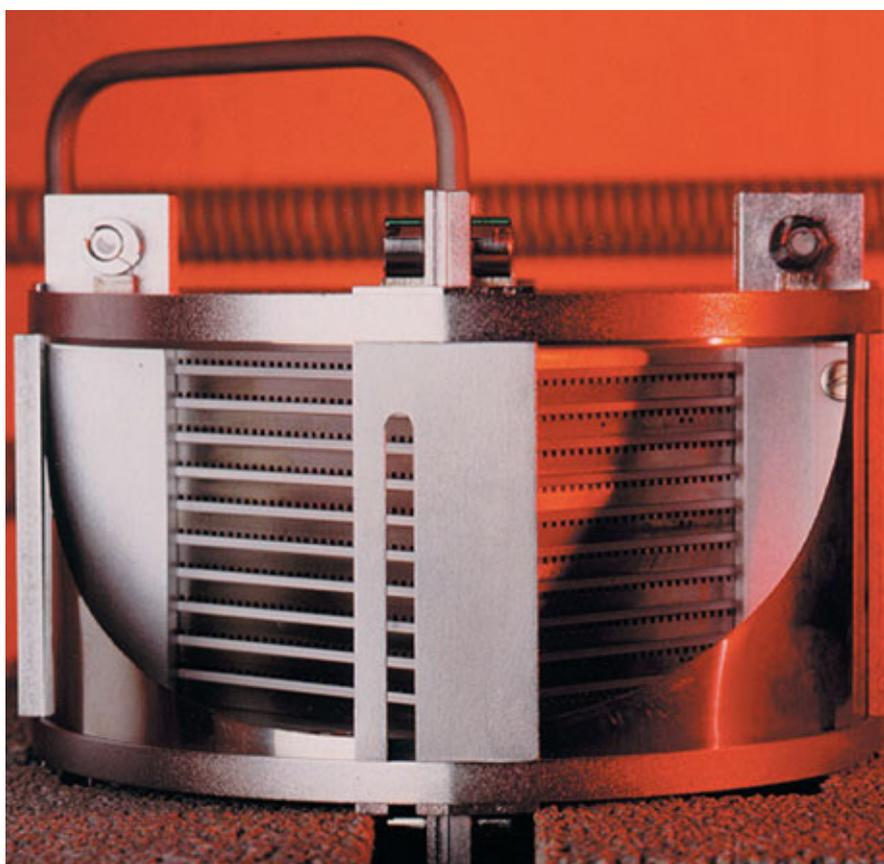
Prototype de pile SOFC réalisé au centre de recherches de Jülich en Allemagne.
