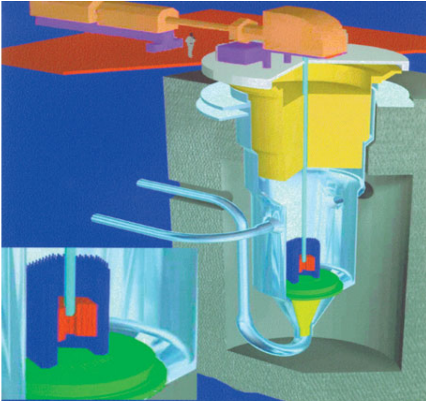
Concept de réacteur hybride capable de transmuter des déchets nucléaires (vue agrandie du cœur en médaillon).
