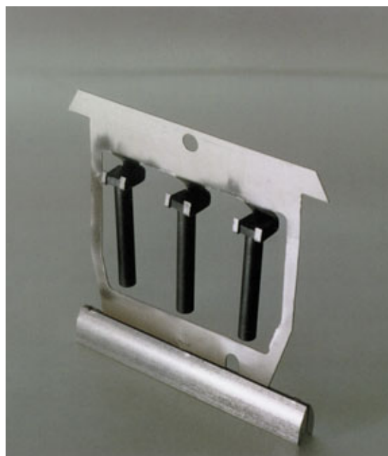
Porte-échantillon en titane (environ 7 X 7 cm), utilisé dans le cadre de l'expérience Mini-Inca pour l'irradiation, dans le réacteur à haut flux de l'ILL à Grenoble, de l'américium contenu dans deux ampoules de quartz placées à l'intérieur des deux tubes en graphite (en noir) latéraux. Un échantillon de fer naturel est disposé à l'intérieur du tube central afin de mesurer le flux neutronique intégré pendant l'irradiation.
