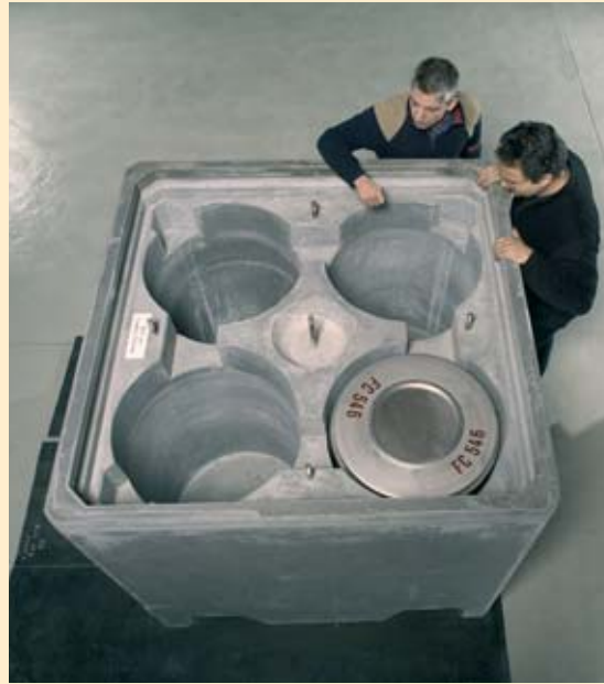
Concept étudié par le CEA de conteneur commun pour l'entreposage de longue durée et le stockage de déchets de moyenne activité à vie longue.
