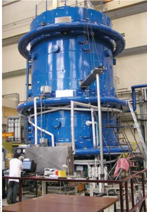
Installation Mistra, au CEA/Saclay, pour l'étude du relâchement d'hydrogène (simulé expérimentalement par de l'hélium) en milieu confiné.
