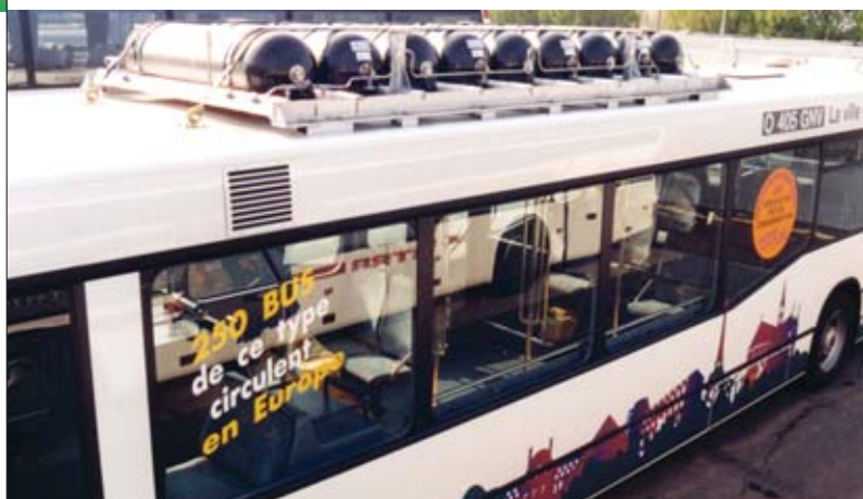
Bus équipé de réservoirs Ullit de gaz naturel. Les opérations de démonstration ont notamment pour objectif de démontrer que l'hydrogène n'est pas plus dangereux que le gaz naturel ou l'essence.
