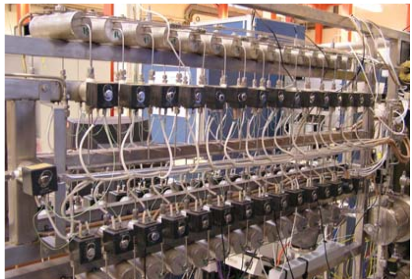
Système d'échantillonneur gazeux de l'installation Mistra, au CEA/Saclay. Relié à un spectromètre de masse, il permet d'établir des cartographies de champ de concentration de l'hydrogène simulé à l'intérieur de l'enceinte.
