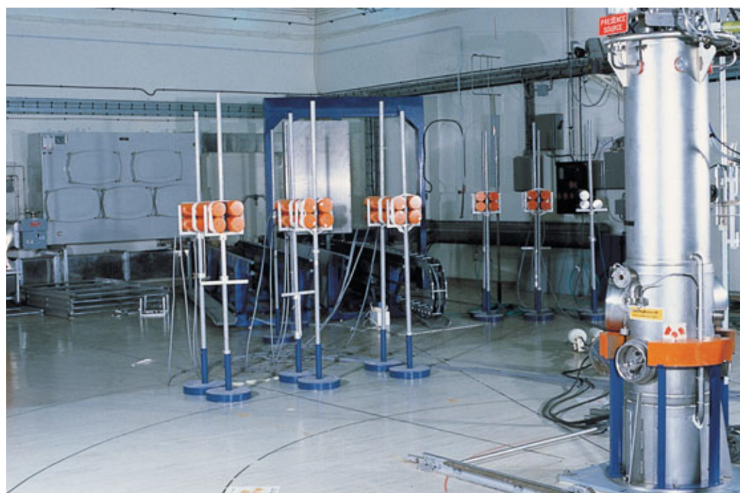
Test auprès du cœur du réacteur Silène de sondes du système de détection d'accident Edac.
