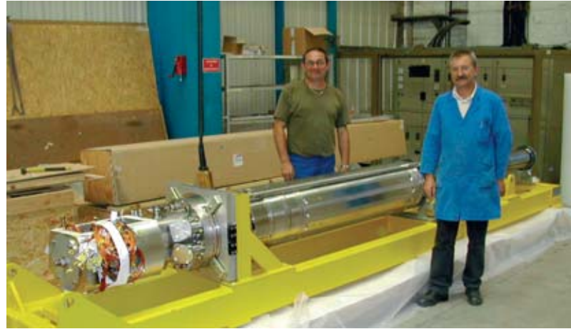
La cible de spallation Mégapie, fabriquée par ATEA en France, avant son expédition en juin 2005 à l'Institut Paul Scherrer (PSI) en Suisse. Les essais hors faisceau précèdent la phase d'irradiation prévue au premier semestre 2006.
