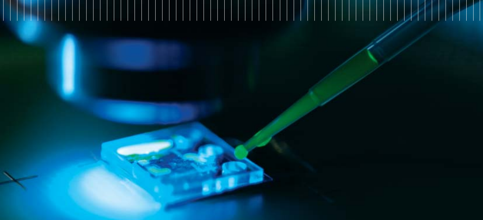
Remplissage avec une solution fluorescente du réservoir d'un laboratoire sur puce développé autour du concept de microfluidique en goutte.
