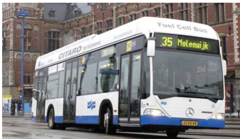
Une dizaine de villes européennes, dont ici Amsterdam, ont commencé à tester des bus électriques Citaro équipés de piles à combustible alimentées en hydrogène.
