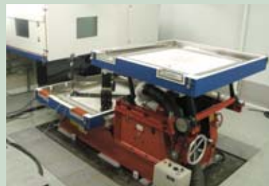
La table vibrante et le caisson climatique de la plate-forme nationale pile à combustible.
