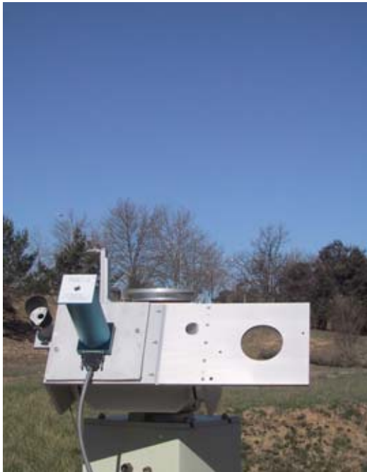
Radiomètre à cavité absolu, permettant la mesure très précise de l'intensité du flux solaire.
