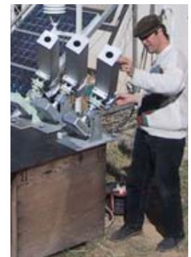
Étalonnage de pyranomètres selon une nouvelle méthode améliorant la précision des mesures. Les trois appareils sont des collimateurs pointés vers le Soleil.
