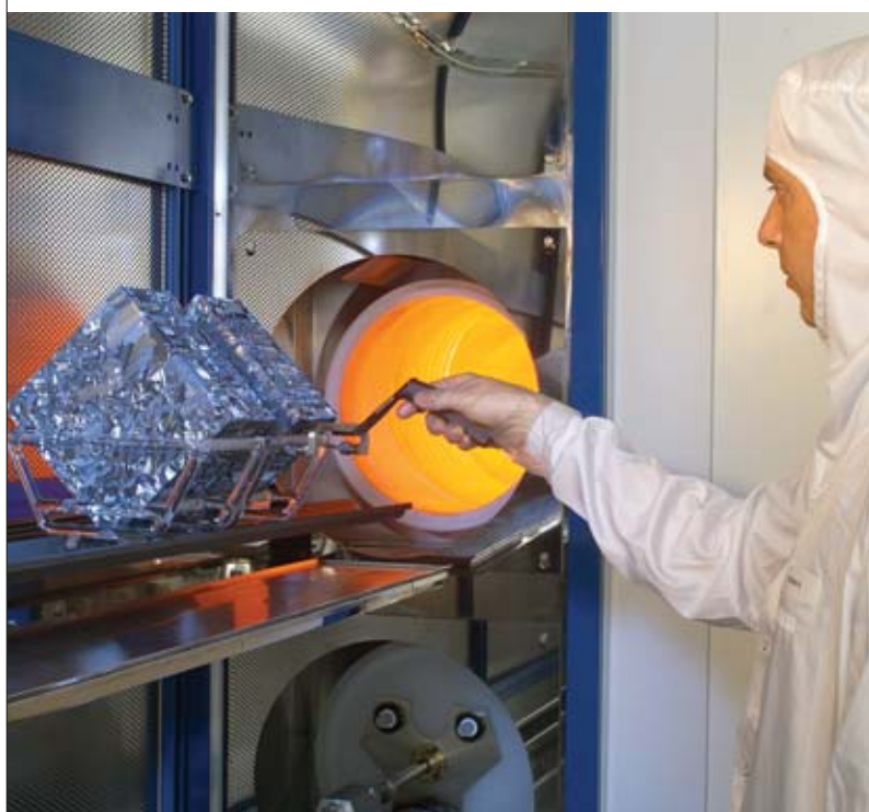
Installation de plaques de silicium de 200 mm × 200 mm sur la pelle de chargement du four de diffusion utilisé pour la formation de l'émetteur de la cellule photovoltaïque. La plate-forme Restaure du CEA/Grenoble est l'une des seules à travailler sur cette surface, le standard étant de 150 mm × 150 mm.
