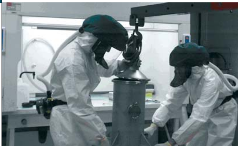
Dépôtage de nanoparticules de SiC obtenues par pyrolyse laser au centre de Saclay. Par précaution, le CEA applique, lors de ce type de manipulation, certaines des techniques de confinement utilisées dans le nucléaire.
