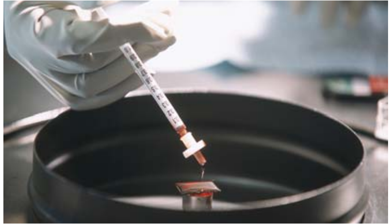
L'une des phases de fabrication des cellules photovoltaïques polymères: le dépôt à la tournette du matériau polymère photoactif.
