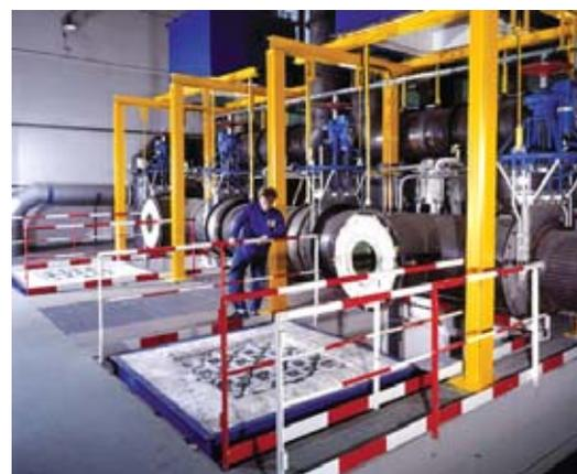
Installation d'essais équipée de deux régénérateurs de 5 m de hauteur permettant d'étudier le comportement thermique de pièces cruciformes et ainsi d'optimiser les configurations d'empilage.
