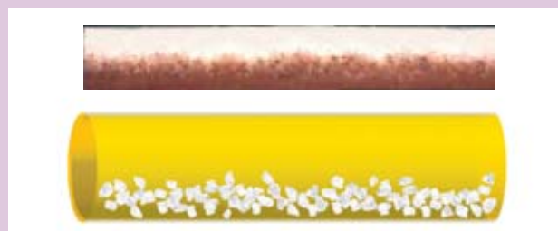
Figure d. Écoulement en lit stationnaire ( V < V^* ).
