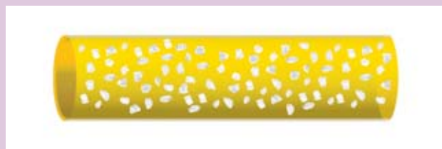
Figure a. Écoulement homogène ( V > V^{***} ).
