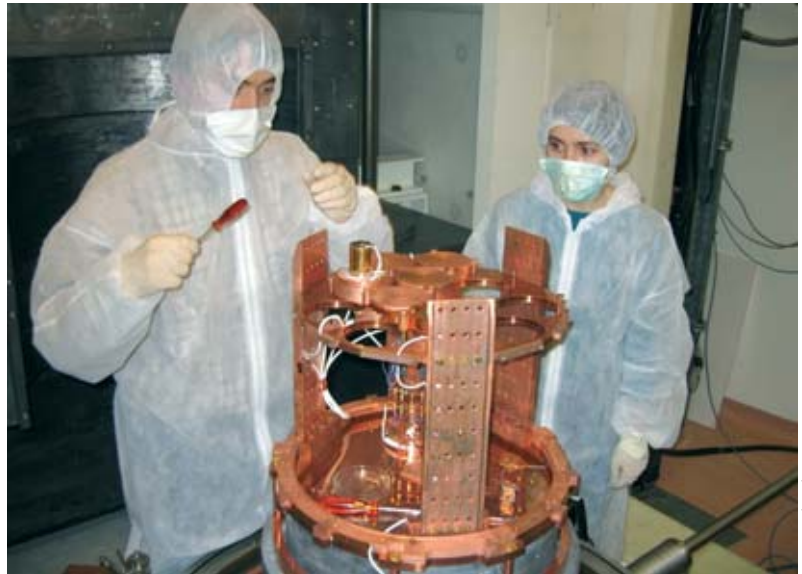
Implantation d'un des dix étages de douze bolomètres de l'expérience Edelweiss II.
