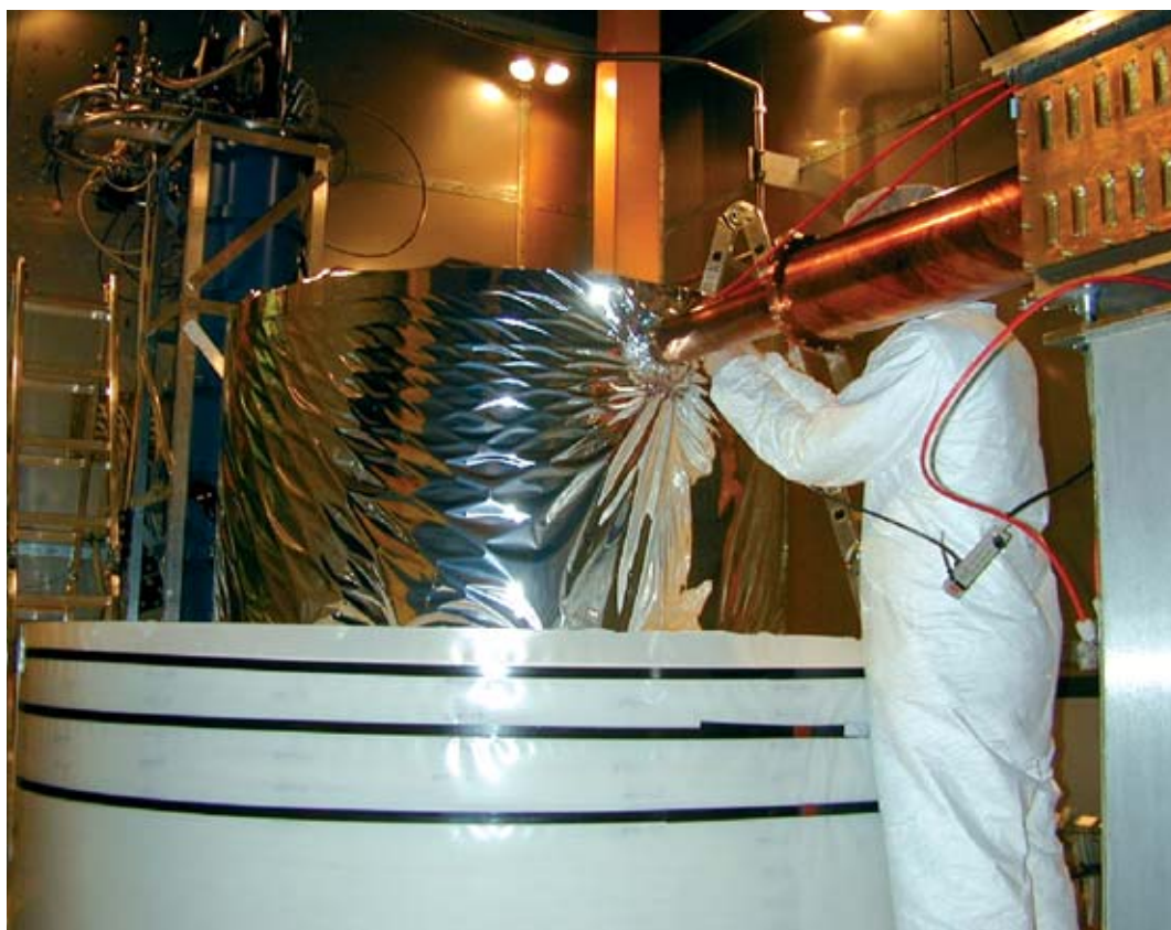
Le réfrigérateur et le cryostat de l'expérience CDMS installés dans la mine de Soudan (Minnesota).
