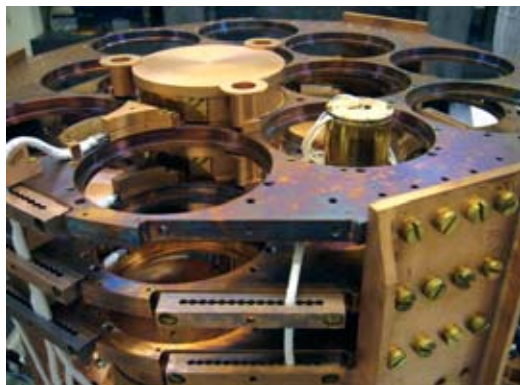
Détail du montage des étages de détecteurs de l'expérience Edelweiss dans le Laboratoire souterrain de Modane.
