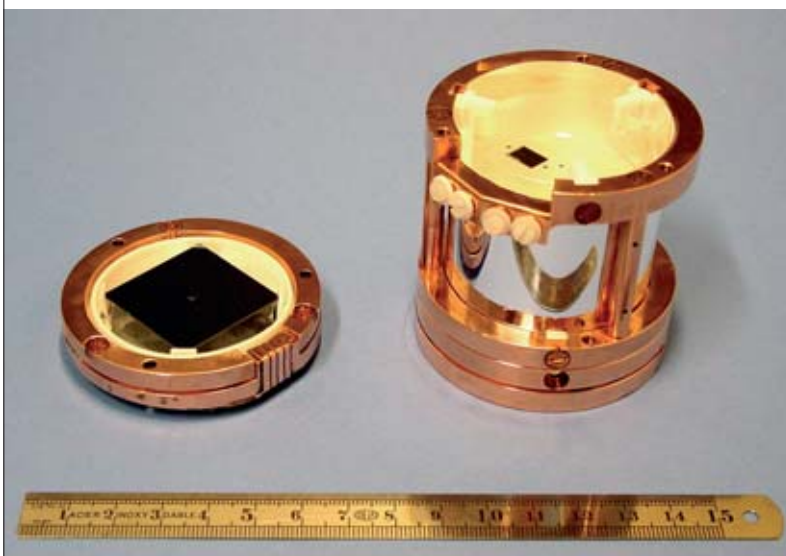
Module prototype de détecteur de l'expérience CRESST II.
