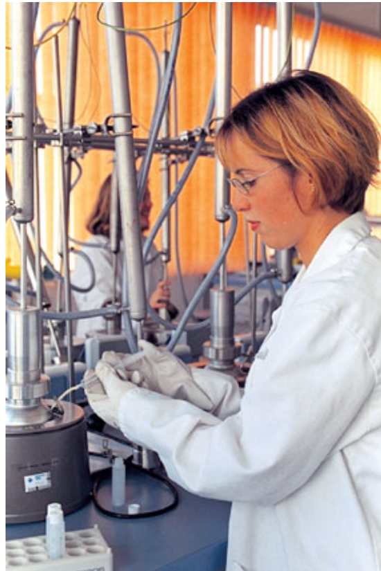
Prélèvement d'échantillons de lixiviat sur un appareillage du type Soxhlet afin d'évaluer les teneurs en éléments relargués par un verre "nucléaire".
