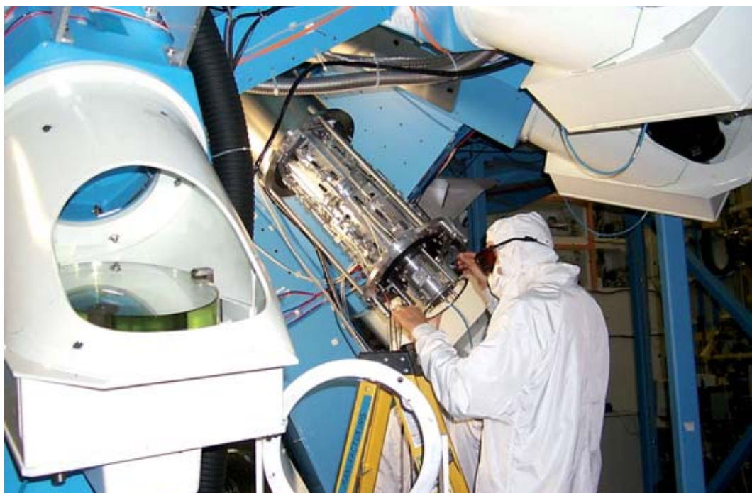
Spectromètre large bande pour la mesure de la température radiative des enceintes installé sur l'installation Omega à l'université de Rochester, aux États-Unis.
