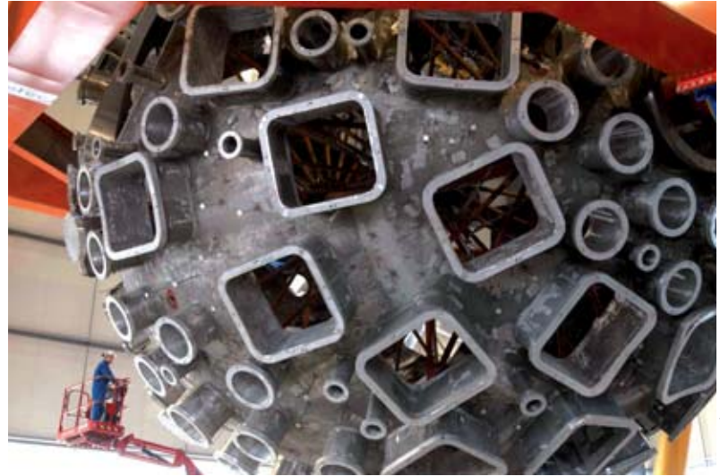
Chambre d'expérience du LMJ en cours d'assemblage sur le site du Cesta. On distingue sur la sphère les orifices de forme carrée par lesquels pénétreront les 240 faisceaux laser (groupés par 4) et ceux, généralement circulaires, réservés aux multiples dispositifs de mesure.
