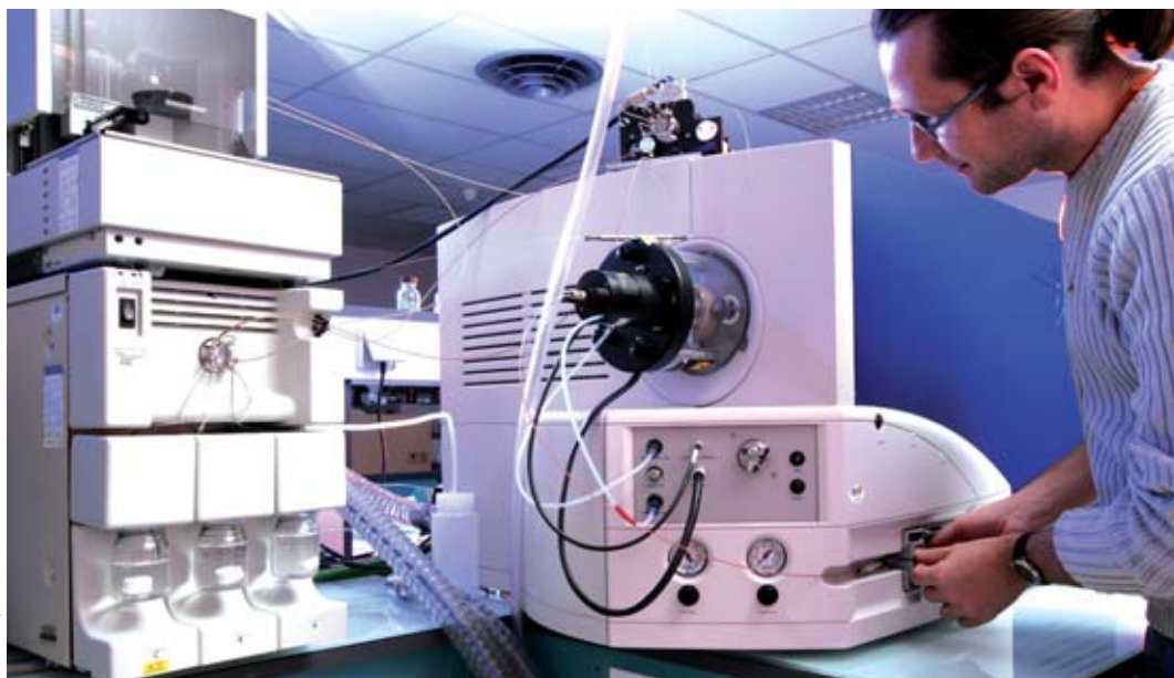
Spectromètre de masse de protéines ESI-Q-TOF couplé à un chromatographe liquide à haute performance et associé à un passeur automatique d'échantillons. Cet instrument présente une grande sensibilité ainsi qu'une excellente résolution et une bonne précision en masse.
