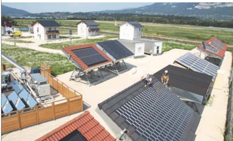
Bancs d'essais de systèmes PV intégrés en toiture de la plateforme expérimentale Incas. L'objectif est de comprendre les phénomènes électriques et thermiques engendrés par l'intégration de modules PV en toiture, d'évaluer les performances de l'installation et de trouver les moyens d'optimiser les rendements électriques.
