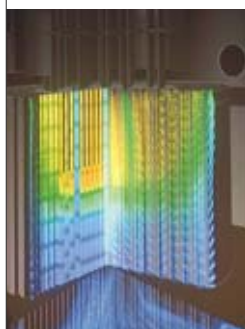
Cœur à faible vidange (CFV) du réacteur ASTRID visualisé sur le mur d'images de la Direction de l'énergie nucléaire. De conception innovante, ce cœur est beaucoup plus robuste lors des accidents de perte globale de refroidissement du cœur.
