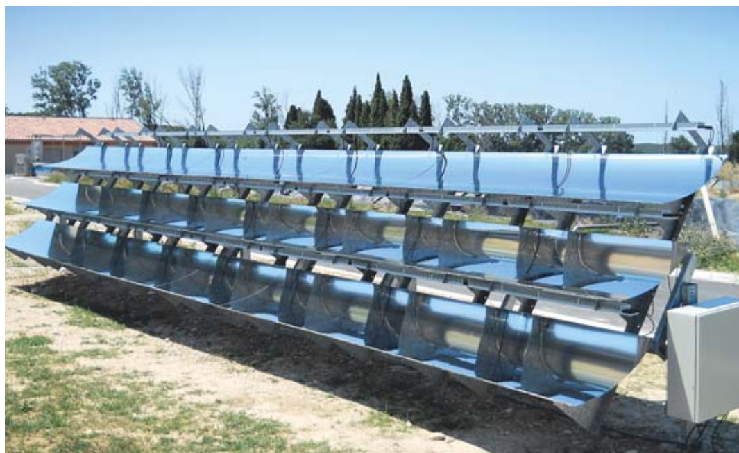
Système de panneaux photovoltaïques à moyenne concentration (MCPV) de la société Axiosun déployé dans le sud de la France. Les systèmes MCPV utilisent des trackers à un axe, orienté ici est-ouest. Les miroirs, qui concentrent la lumière sur les modules CPV, sont bien visibles. Ces derniers sont collés à des dissipateurs de chaleur à ailettes pour limiter l'augmentation de la température au niveau des cellules.
