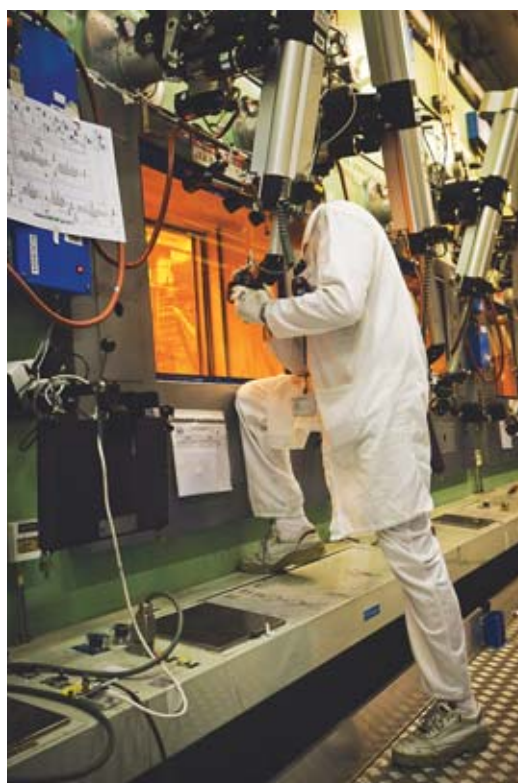
Intervention au télémanipulateur dans la Chaîne blindée procédé (CBP) de l'installation ATALANTE située au centre CEA de Marcoule. C'est dans cette chaîne blindée que la démonstration de la faisabilité technique de nombreux procédés a été réalisée, tels les procédés SANEX, DIAMEX, GANEX et EXAM.
