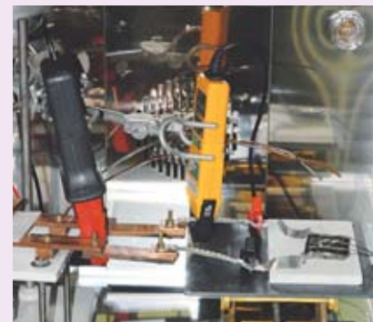
Essai électrique de court-circuit. Le court-circuit est provoqué en mettant en relation le pôle positif et le pôle négatif d'un accumulateur à l'aide d'un conducteur métallique de résistance négligeable. Cet essai simule un court-circuit externe.
