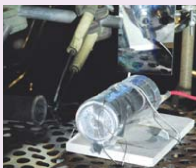
Essai thermique : incendie par chauffage au chalumeau. Cette expérimentation consiste à aggraver thermiquement un accumulateur par chauffage au chalumeau, à observer son comportement au cours du temps et à tester les moyens usuels d'extinction (eau, CO 2 ...).
