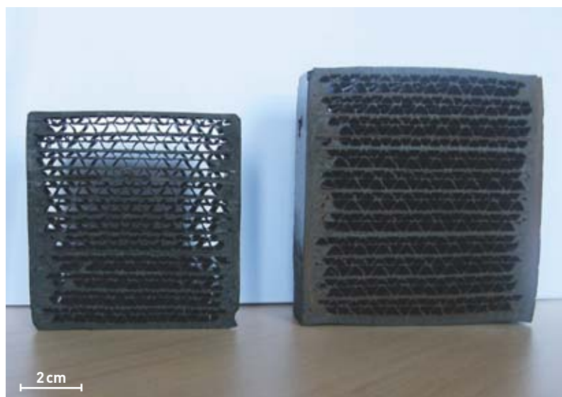
Électrode traversante avant calcination (à droite, composite de résine phénolique et de cellulose ) et après calcination (à gauche, carbone vitreux, matériau carboné de faible densité).
