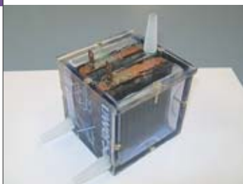
Prototype de réacteur à électrodes nid-d'abeilles traversantes (à gauche) à partir duquel un prototype de batterie redox à circulation Pb-AMS a été construit (à droite). On distingue le réservoir d'électrolyte, la pompe (en blanc), le réacteur et les indicateurs de circulation d'électrolyte (en bleu et en noir).
